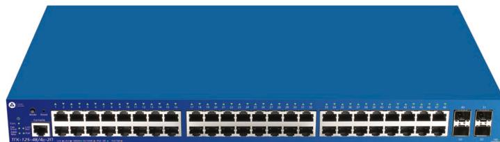
Настраиваемый коммутатор ТГК-125-48/4д-2П, оснащенный 48 портами 10/100/1000Base-T с поддержкой PoE и 4 портами 10GBase-X SFP+, поддерживает расширенные функции управления и безопасности, обеспечивая высокую производительность и масштабирование сети. Функции управления включают SNMP, управление на основе Web-интерфейса и интерфейс командной строки (CLI).
